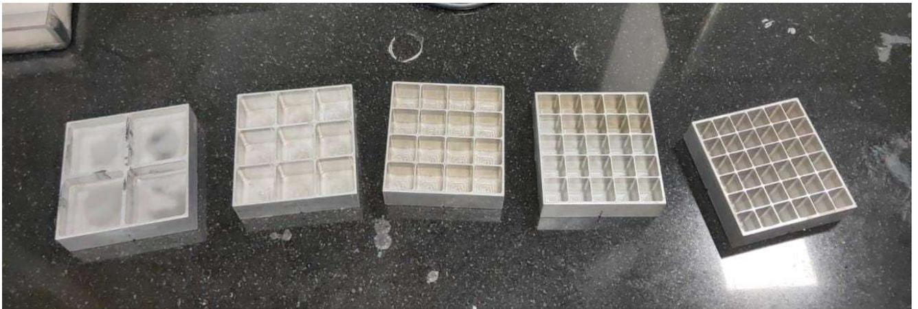
**Fig. 5 Aluminum cross fin Heat Sink Configurations (a) 2x2 (b) 3x3 (c) 4x4 (d) 5x5 (e) 6x6**
