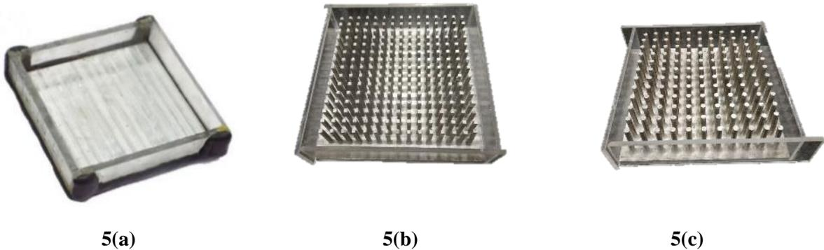
**Fig. 5 Aluminium pin fins Heat Sink Configurations (a) No fins (b) Square pin fins (c) Circular pin fins**
